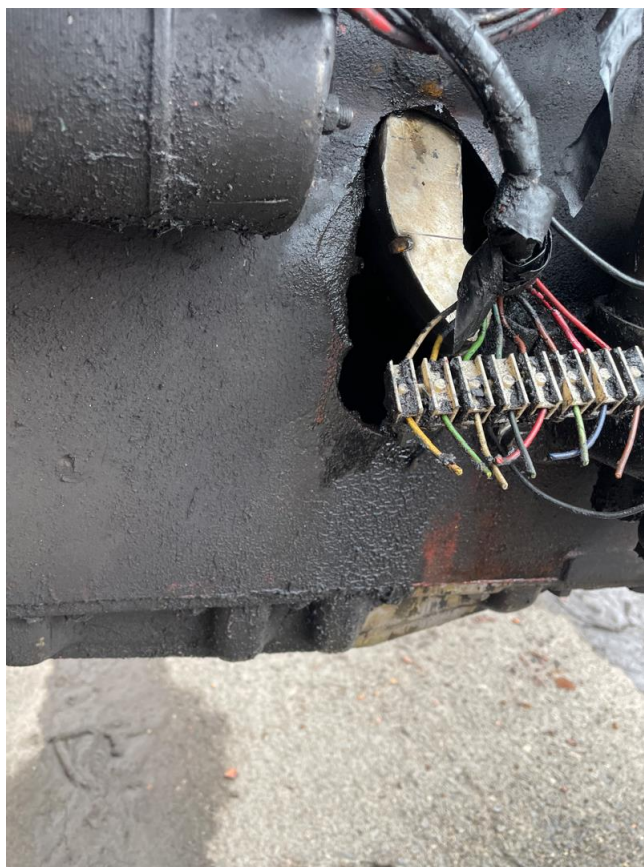
poškozený blok motoru
